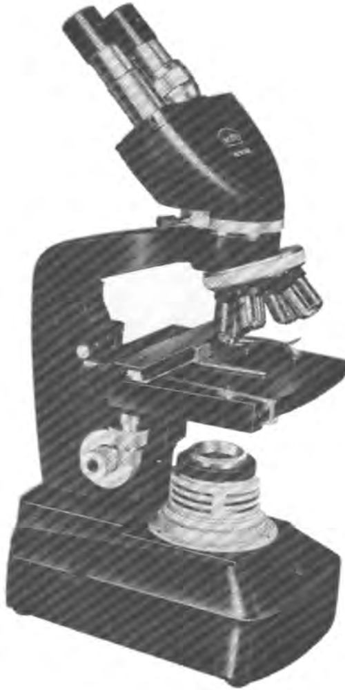
شكل ٣ - ١١ : مجهر مركب كهربائي الإضاءة ثنائي العينات .
