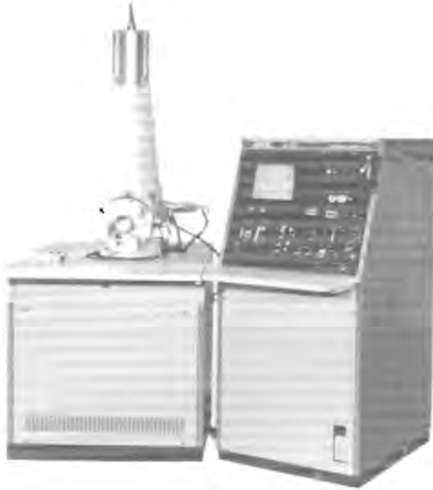
شكل ١٢ - ١ : المجهر الإلكتروني المساح من نوع (JSM-35C). (الصورة من شركة جيول)
