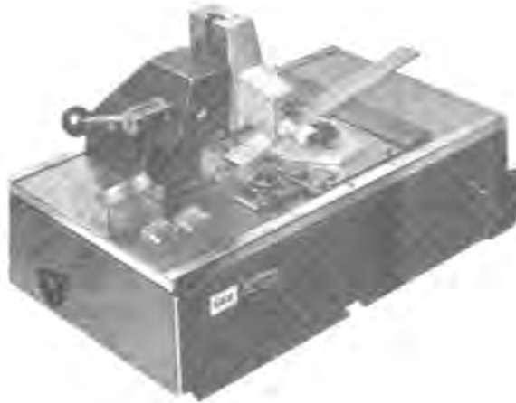
شكل ١٠ - ١ : جهاز تحضير السكاكين الزجاجية (الصورة من شركة LKB)
